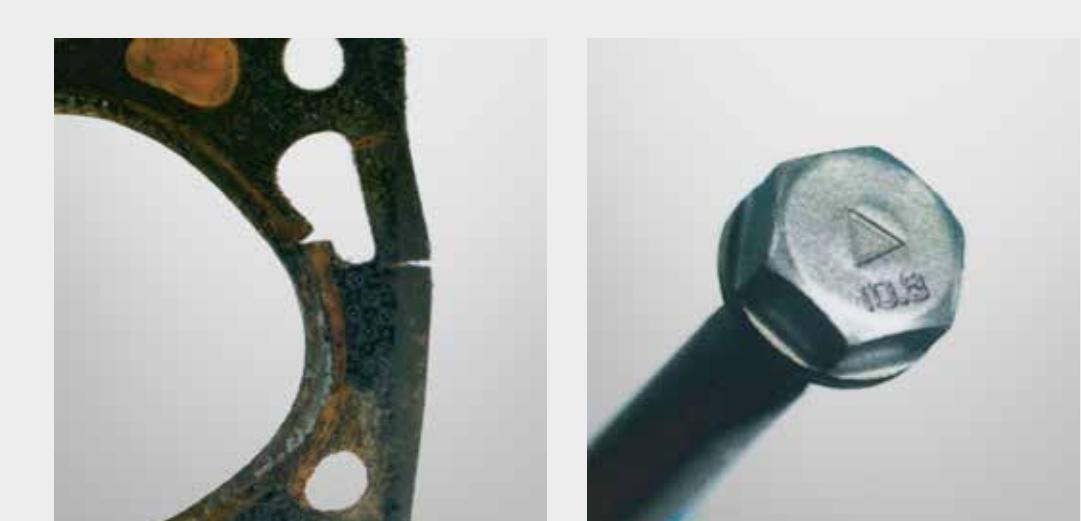
**Признаки:** Смещение материала прокладки, разломы усилительных металлических колец отверстий. Течь прокладки уже после первых тысяч километров пробега.
