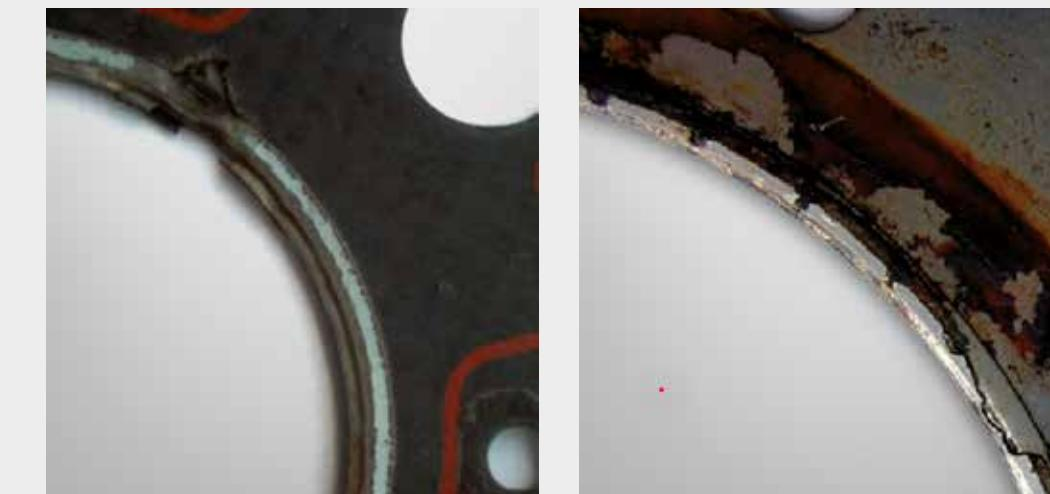
**Признаки:** Прогар материала прокладки между цилиндрами или в местах где происходило калильное или детонационное воспламенение. Явные следы протекания газов сгорания.
