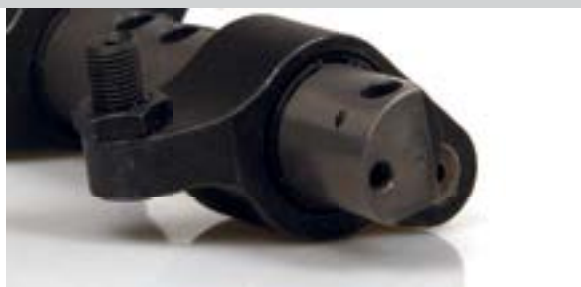
(Рис. 3) Коромысло клапана системы впрыска типа PD - отсутствует заглушка масляного канала
