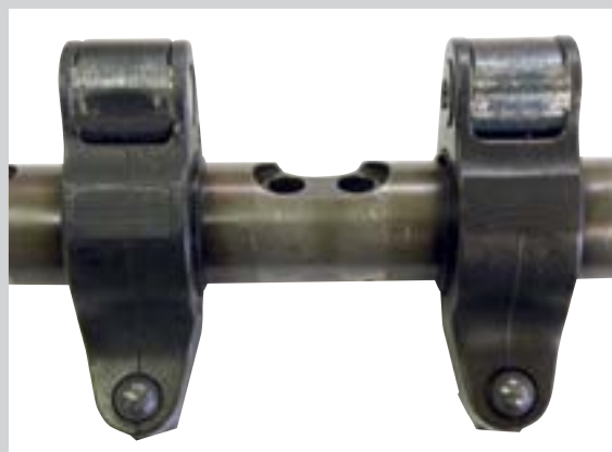
(Рис. 4) Коромысло клапана системы впрыска типа PD - Сильный износ поверхности роликов
