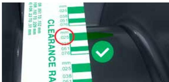
Инструмент для измерения зазора в подшипнике скольжения от Glyco:
