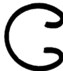
Рисунок 2 – Замок из проволоки прямоугольного сечения
